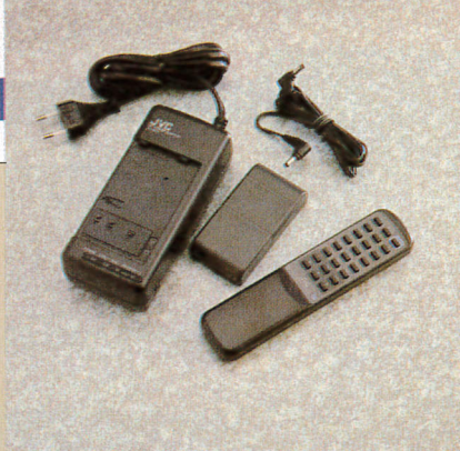
Qui c'è tutto quello che non era possibile mettere dentro l'XM-D1: alimentatore con possibilità di scarica/ricarica rapida della batteria, telecomando, cavi.
